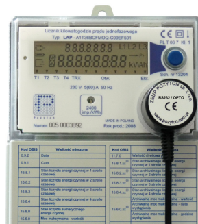
Rys. 2. Licznik LAP z głowicą optyczną
