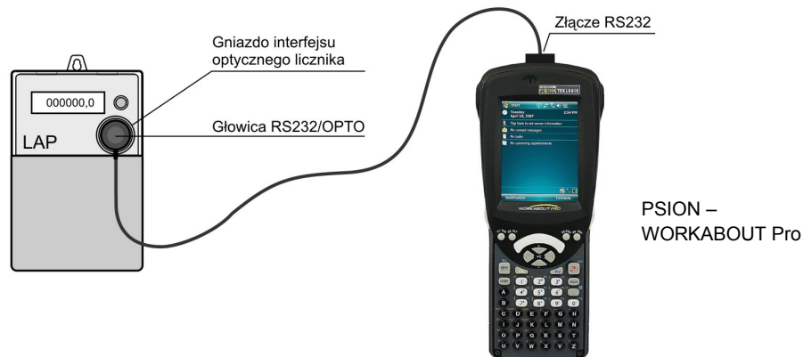
Rys. 1. Podłączenie licznika LAP do urządzenia mobilnego
