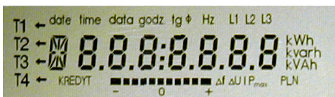
Możliwości prezentacyjne dedykowanego wyświetlacza LCD zastosowanego w liczniku LA4-M
