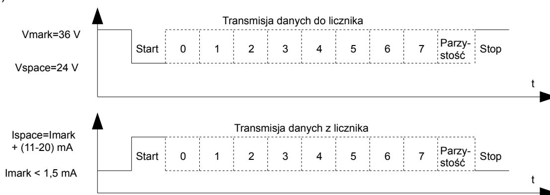
Rysunek 2.1 Sposób transmisji danych przez interfejs M-Bus
