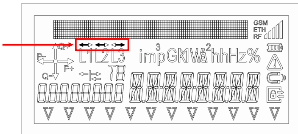
Rys. Symbol prezentacji kierunku przepływu prądów fazowych
